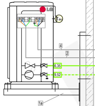
Aussengerät mit Dämpfungssockel
