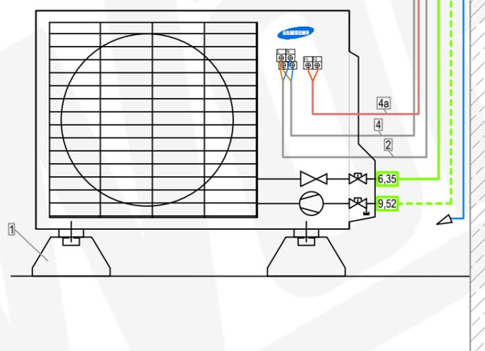
Kondensatablauf mit Kanalpumpe FL-K20K-SW links
