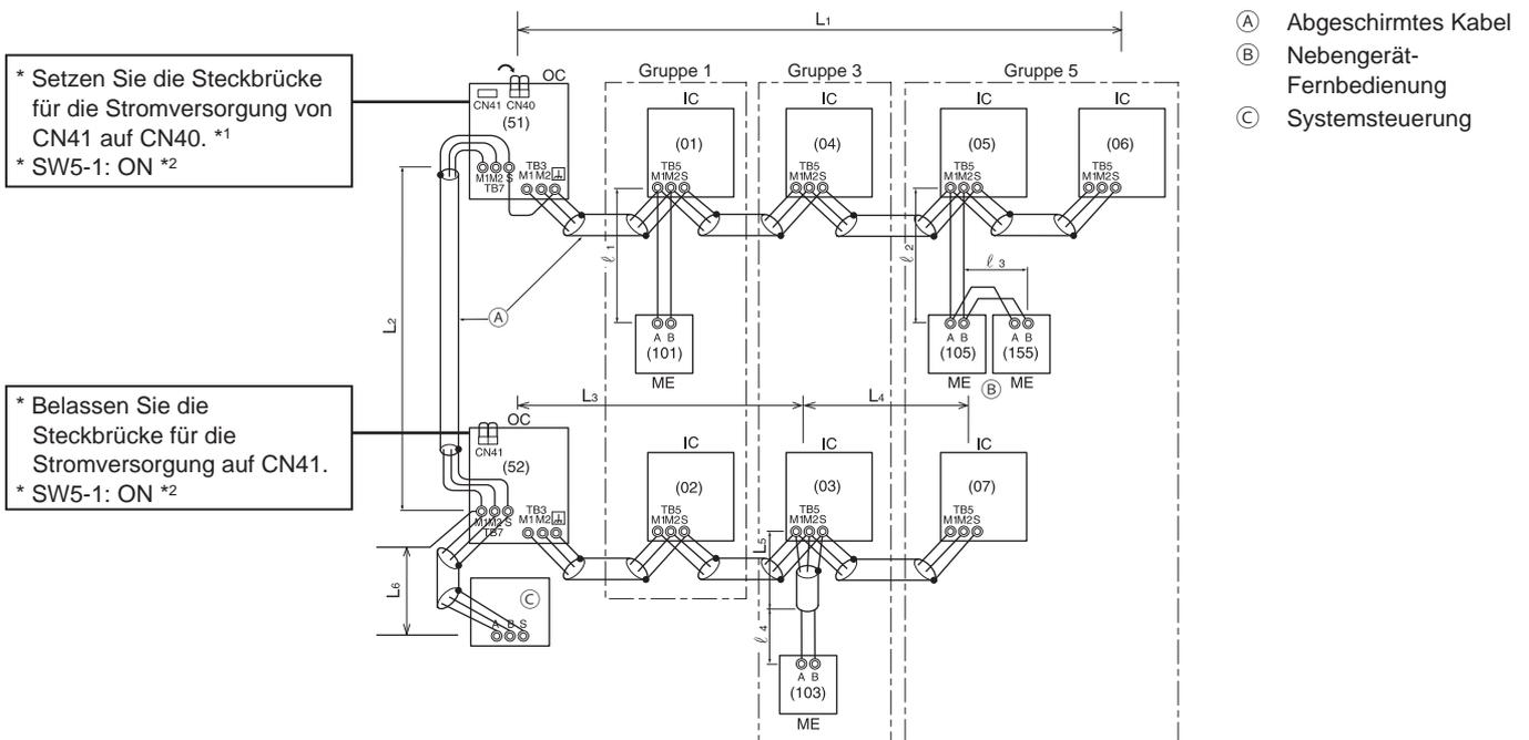
\*1 Ist ein Netzteil nicht an das zentrale Kontroll-Übertragungskabel angeschlossen, setzen Sie in nur einem der Außengeräte die Steckbrücke für die Stromversorgung von CN41 auf CN40.
