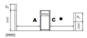
$h_2 > 0 \rightarrow A \ge A + \frac{h_2}{2}$  $h_1 > 0 \rightarrow C \ge C + \frac{h_1}{2}$
