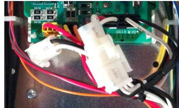
Der Stecker X6Y ist zu lösen und mit X6YB zu verbinden
