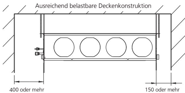
Revisionsöffnung für Service- und Wartungsarbeiten Revisionsöffnung vorsehen.
