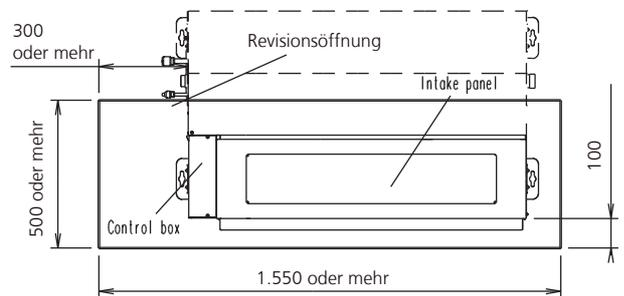
Bei Verwendung eines Kanals
