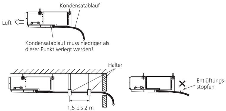
Der Außendurchmesser beträgt 38mm, nutzen Sie einen entsprechenden Querschnitt.
