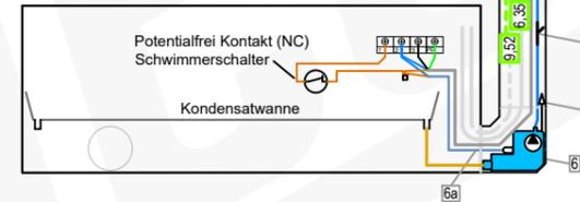
Kondensatablauf mit Kanalpumpe FL-K20K-SW links
