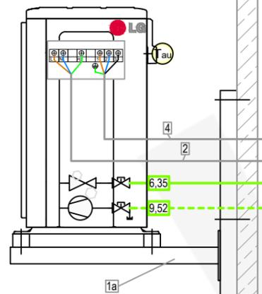
Aussengerät mit Dämpfungssockel
