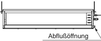
**Deckeneinbaukanal - mittel statisch**
