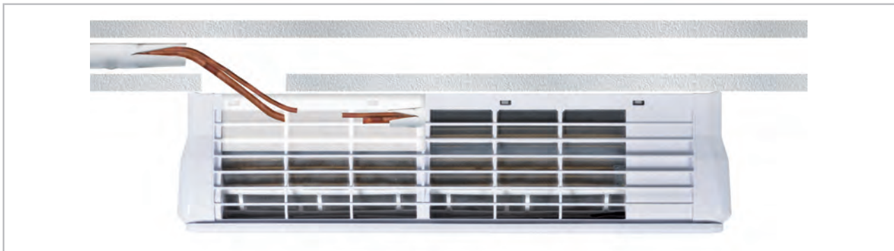
Abb. 20: Unterputzinstallation der Kältemittelleitungen (Ansicht von oben)
