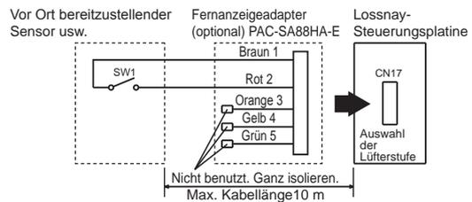
Verwenden Sie diese Funktion, um durch den externen Sensor bei einer Verunreinigung der Raumluft auf Hoch zu schalten, während das System normalerweise im Modus Niedrig arbeitet.
