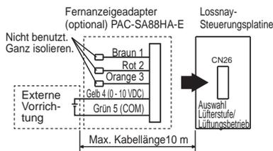
Um die Lüfterstufe über den Eingang 0 - 10 V Gleichstrom umzuschalten, muss eine Verkabelung wie in der Abbildung oben vorgenommen werden. Details finden Sie unter der Funktionseinstellung **Nr. 63**.
