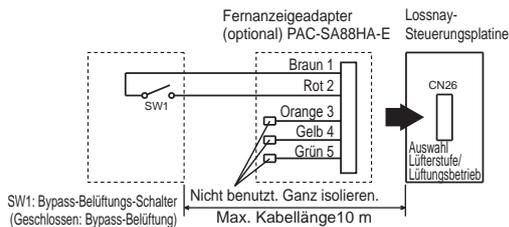
Steht SW1 auf "ON (EIN)", schaltet der Lüfter der Lossnay-Einheit auf Bypass-Belüftung, unabhängig von der Einstellung an der Fernbedienung.
