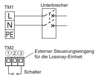
Starten/Stoppen Sie das Gerät durch einen Schalter, der an TM2 (1, 2) angeschlossen ist.
