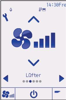
Jede Betätigung der Tasten ▼ oder ▲ schaltet durch die folgenden Lüfterdrehzahlen.
