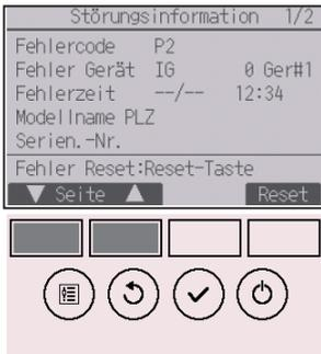
Fehlercode, das die Störung verursachende Gerät, Kältemitteladresse, Gerätemodellname und die Seriennummer werden angezeigt. Der Modellname und die Seriennummer erscheinen nur, wenn sie vorher eingegeben wurden.
