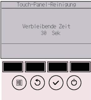
Dieser Bildschirm ermöglicht es dem Benutzer, das Touch-Panel 30 Sekunden lang abzuwischen, ohne dass es auf Eingaben reagiert und Einstellungen versehentlich geändert werden.
