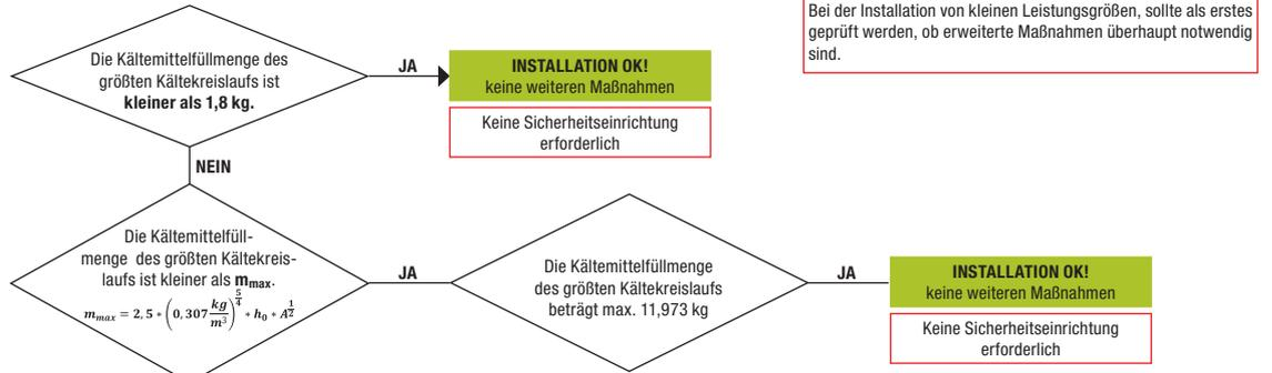
Bei der Installation von kleinen Leistungsgrößen, sollte als erstes geprüft werden, ob erweiterte Maßnahmen überhaupt notwendig sind.
