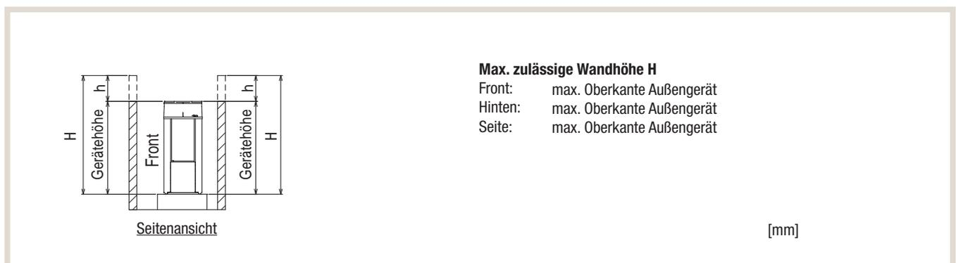
**2.3.3 Bei Einzelinstallation mit PUHY-(E)M500 YNW-A1**
