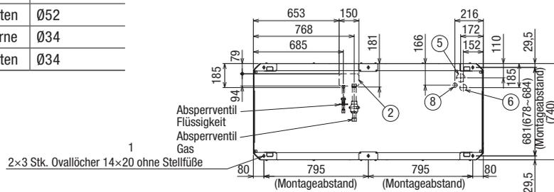
**Kältetechnische Anschlussmaße (Alle Lötanschluss)**
