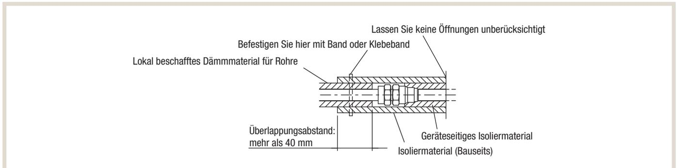
Die Dämmstoffe für die vor Ort anzubringenden Rohre müssen den folgenden Spezifikationen entsprechen:
