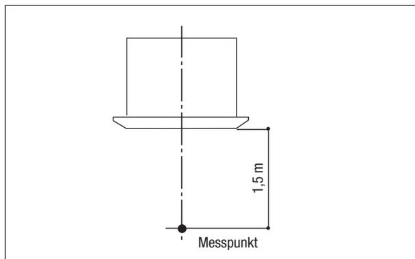
Schalldruckpegel gemessen 1,5 m unter dem Gerät
