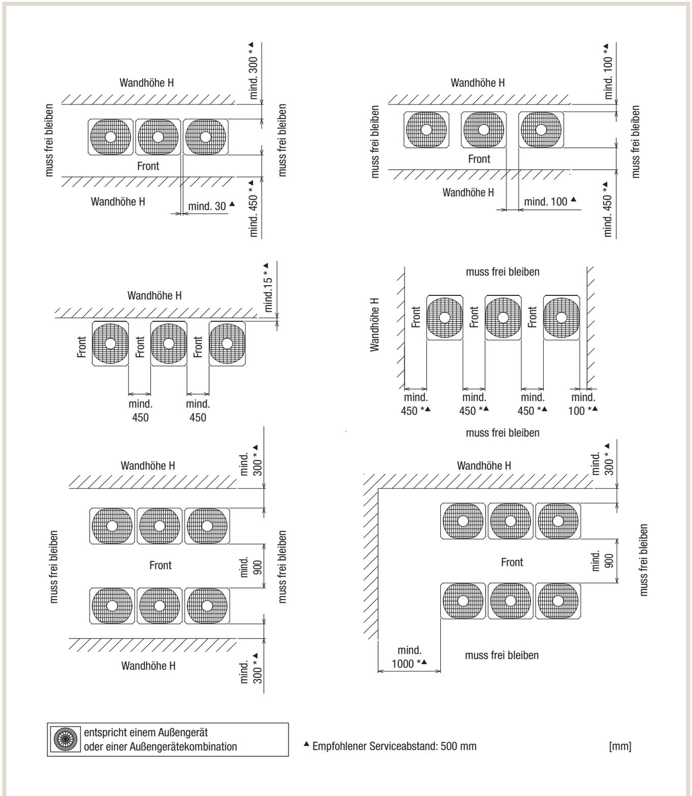
**2.3.5 Bei Mehrfachinstallation mit PUHY-(E)M350, 400, 450 YNW-A1**
