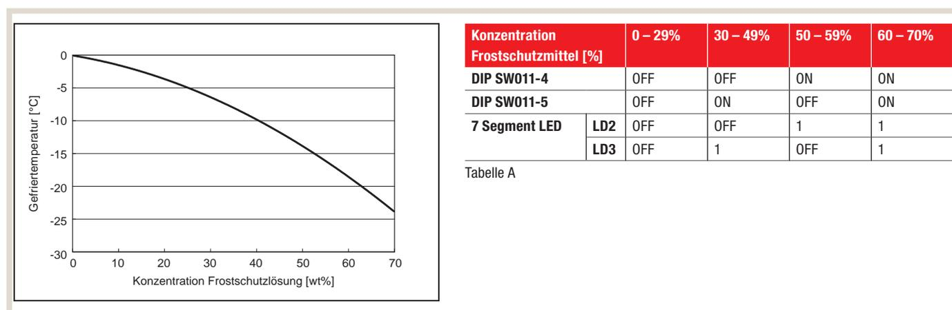
**7.6.2 Leistungskorrektur durch Frostschutzmittelkonzentration (Kühlen)**
