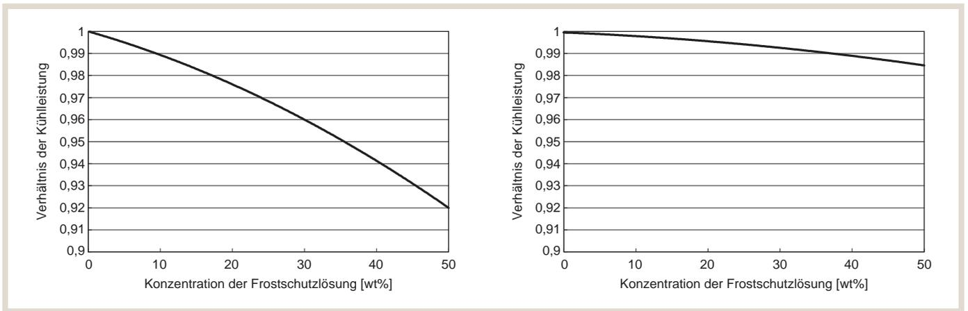
**7.6.3 Leistungskorrektur durch Frostschutzmittelkonzentration (Heizen)**
