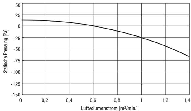
Multi-Funktions-Luftkasten + Standard-Luftfilter
