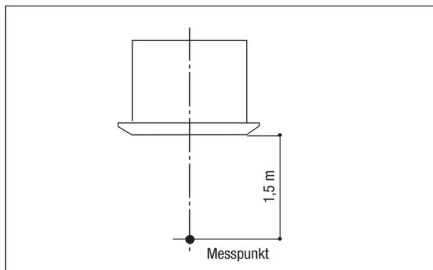
Schalldruckpegel gemessen 1,5 m unter dem Gerät
