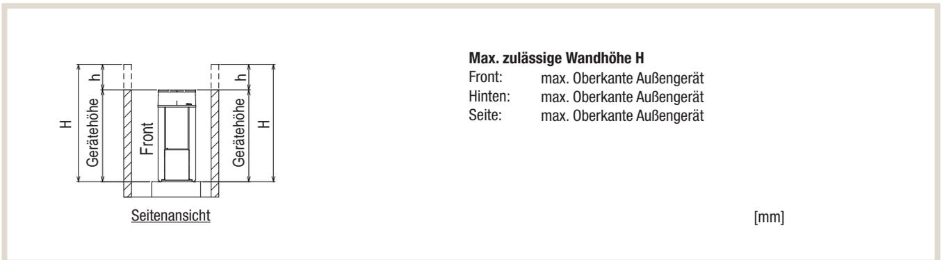
**2.3.4 Bei Mehrfachinstallation mit PUHY-(E)M200, 250, 300 YNW-A1**
