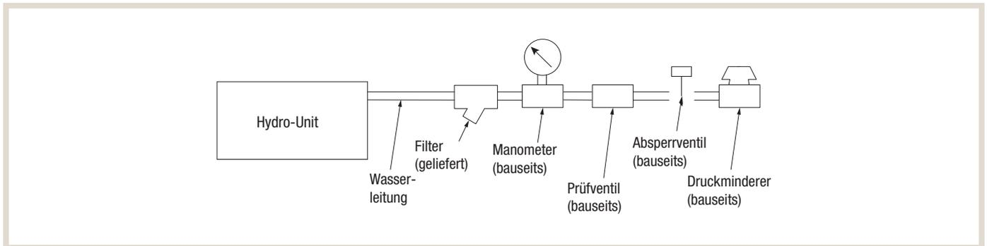
10. Verwenden Sie die Formel:  $0,1 \text{ [MPa]} < 0,01 + 0,01 \times A < 0,16 \text{ [MPa]}$  für den zu verwendenden Versorgungsdruckbereich. (A: Kopfdruck (m) zwischen der Hydro-Unit und dem höchsten Innengerät). Wenn der Versorgungsdruck größer als 0,16 MPa ist, verwenden Sie ein Druckminderventil, um den Druck innerhalb des Bereichs zu halten. Wenn der Kopfdruck unbekannt ist, stellen Sie ihn auf 0,16 MPa ein.
