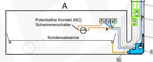
Kondensatablauf mit Kanalpumpe FL-K20K-SW links
