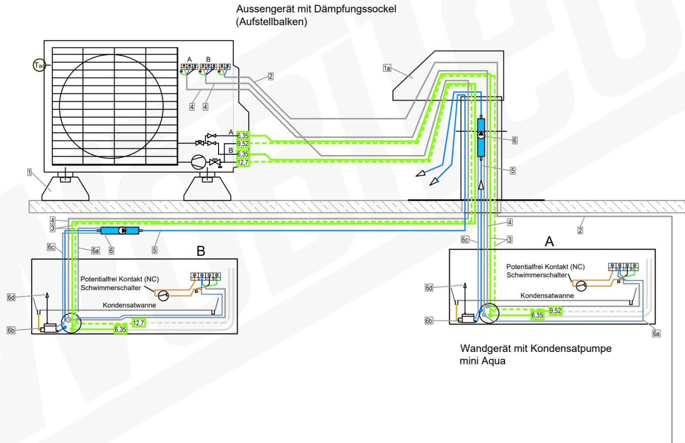
**Zubehör Wandgerät mit Kondensatpumpe mini aqua**
