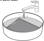
Verwenden Sie keine Reinigungsmittel. Nicht schrubben. Dies kann zur Beschädigung des Aktivkohlefilters führen.
