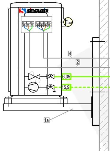
Aussengerät mit Dämpfungssockel
