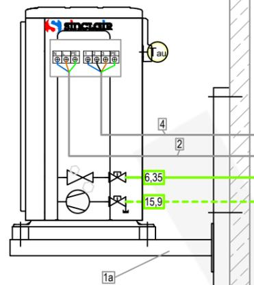
Aussengerät mit Dämpfungssockel
