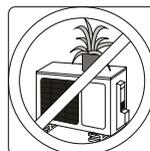
**ACHTUNG:** Blockieren Sie die Lüftungsöffnung nicht und stellen Sie keine Gegenstände darauf ab. Stellen Sie die automatische Luftleitlamelle nicht manuell ein und stecken Sie nicht Ihre Hände in die Luftkanäle des Gerätes. Decken Sie den Lufteinlass und die Lüftungsöffnung nicht mit Gegenständen ab.
