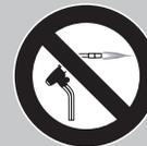
Das abgedrehte Rohrleitungsende NIEMALS durch Löten entfernen.
