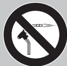
Das abgedrehte Rohrleitungsende NIEMALS durch Lötens entfernen.
