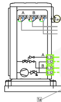
Aussengerät mit Dämpfungssockel
