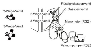
2. Öffnen Sie den Hebel am Manometer, und starten Sie die Vakuumpumpe. Wenn die Skala des Messgeräts (Niederdruck) das Vakuum erreicht, prüfen Sie Schritt 1 erneut.
