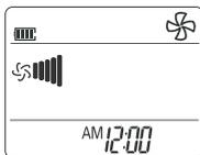
In dieser Betriebsart zirkuliert die Luft, ohne Kühlung oder Heizung zu bewirken. Sie kann durch Drücken der BETRIEBSARTWAHLTASTE aktiviert werden. Sobald die Luftzirkulation aktiviert wurde, können Sie die Lüfterdrehzahl durch Drücken der Taste LÜFTER-GESCHWINDIGKEIT auswählen.
