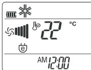
Diese Betriebsart dient zum energiesparenden Kühlungsbetrieb. Hierbei wird der Betrieb durch Einstellung der Anpassungsdauer des Körpers, je nach der Uhrzeit und Temperatur, sowie durch die automatische Einstellung der gewünschten Temperatur optimiert.
