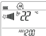
In dieser Betriebsart werden grundsätzlich nur der Heiz- und der Kühlungsbetrieb des Klimagerätes gesteuert. Im Automatikbetrieb werden grundsätzlich nur der Heiz- und der Kühlungsbetrieb des Klimagerätes gesteuert. In dieser Betriebsart wird der Betriebsmodus automatisch so gewählt, dass die Temperatur innerhalb von  $\pm 2^{\circ}\text{C}$  der eingestellten Temperatur gehalten wird.
