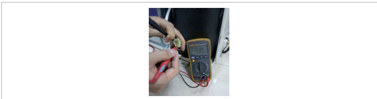
Abb. 25: Messung der Widerstandswerte mit dem Multimeter
