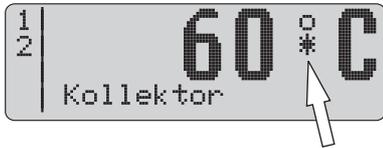
Bild 6-4 Betriebsanzeige bei aktivem Frostschutz
