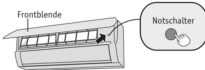
Gerät einschalten: Notschalter (siehe Bild) drücken. Gerät startet im AUTO-Modus. Die Betriebsart (COOL, HEAT, FAN) wird je nach vorherrschender Raumtemperatur automatisch gewählt.
