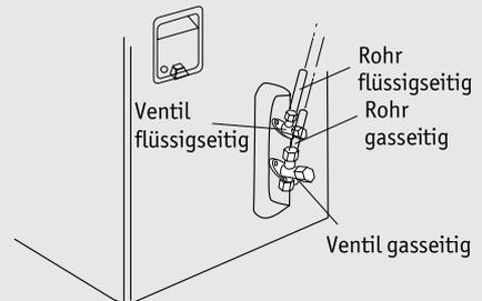
3. Ziehen Sie die Überwurfmutter zuerst von Hand an.
