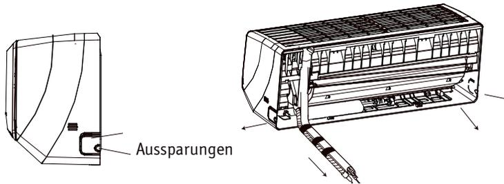
Rohrführung so umwickelt wie im Querschnitt (siehe Bild) gezeigt, nach außen führen.
