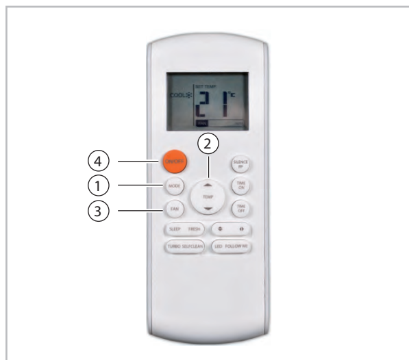
Abb. 11: Modus "Kühlen", "Heizen" und "Umluft"
