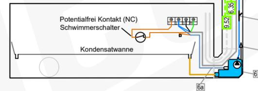
Kondensatablauf mit Kanalpumpe FL-K20K-SW links
