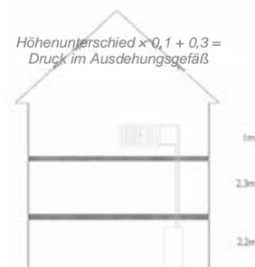
Beispiel: Der Höhenunterschied zwischen Ausdehnungsgefäß und Heizkörpern beträgt ca. 5,5 m, wenn sich der Tank im Keller befindet und die Heizkörper im Dachboden:
