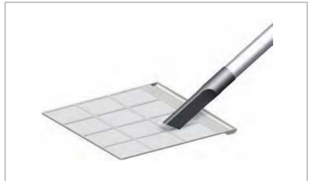
Abb. 39: Reinigung mit dem Staubsauger
