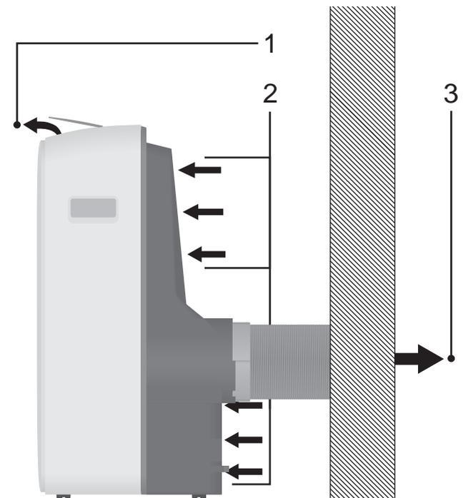
Bild 4: Seitenansicht des Klimageräts im Kühlbetrieb mit angesgeschlossenem Spiralschlauch.
