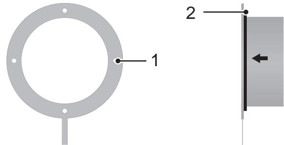
Bild 11: Montage des Wandauslasses. Der Pfeil zeigt die Kleberichtung des Dämmstoffes an.
