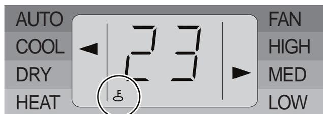
Bild 29: Wenn die Fernbedienung gesperrt wird, erscheint auf der Anzeige ein Schlüssel.
