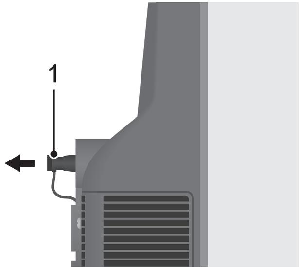
Bild 15: Gummiverschluss am Kondensatanschluss.
