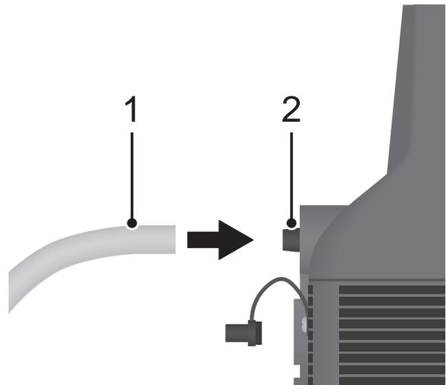
Bild 16: Anschluss des Kondensatschlauchs.
