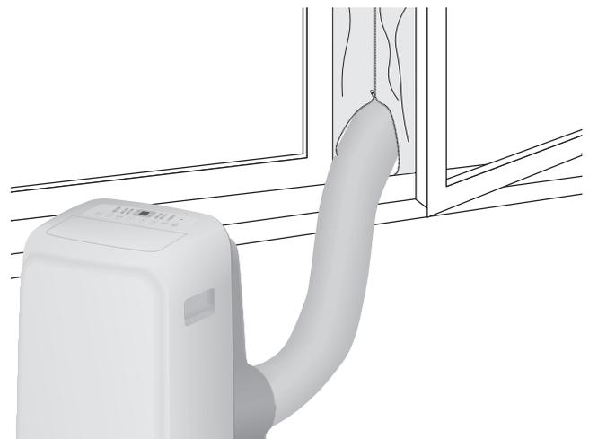
Bild 13: Bei Flügelfenstern und Türen sind Abdichtungen mit Reißverschluss eine geeignete Lösung. Der Schlauch wird ohne Adapter durch die Abdichtung gehängt.
