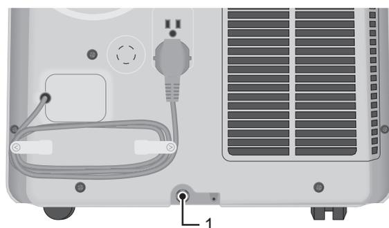
Bild 30: Verschlusskappe des Kondensatablaufs.
