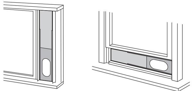
Bild 12: Fensteranschluss für Schiebefenster und Rollos.
