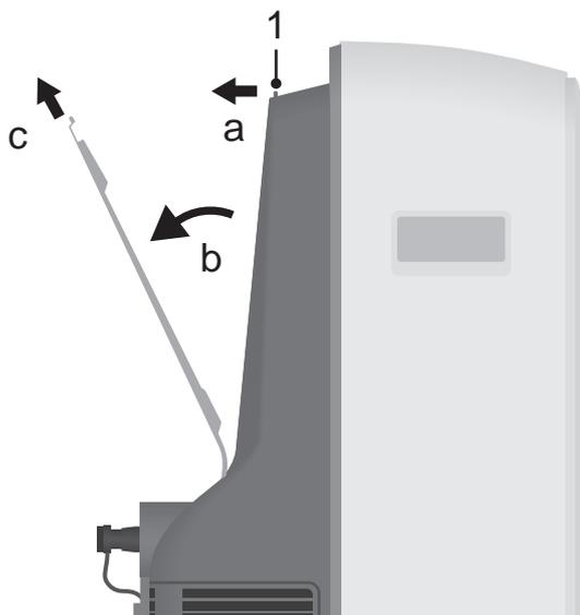
Bild 31: Entnehmen des oberen Luftansauggitters.
