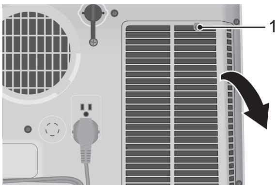
Bild 32: Entnehmen des unteren Luftansauggitters.
