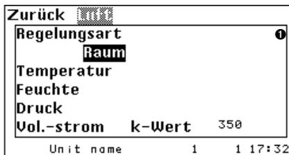
Hier wählen Sie die Regelungsart. Die Anzeige der Istwerte ändert sich entsprechend der eingestellten Regelungsart (Raum / Zuluft). ❶
