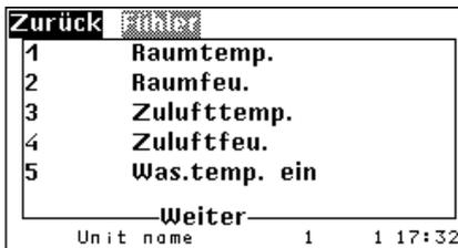
Nach Auswahl des Sensors können Sie im folgenden Fenster die Verzögerung für den Grenzwertalarm ① und die Verzögerung für den Fühlerbruchalarm ② in Sekunden eingeben.
