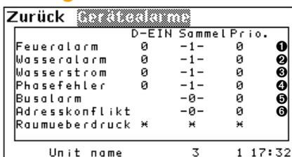
In diesem Fenster können Sie den Gerätealarmen digitale Eingänge (①-④)**a** zuordnen, festlegen, ob der entsprechende Alarm einen Sammelalarm (①-⑥)**b** auslösen soll und den Alarm einem Alarmrelais (①-⑥)**c** zuordnen.
