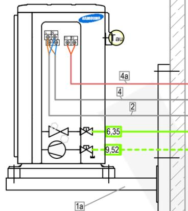
Aussengerät mit Dämpfungssockel
