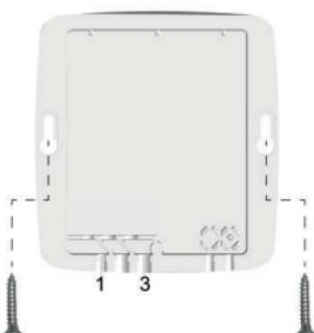
4. Schließen Sie die Gateway-Kabel an.
