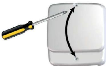
3. Montieren Sie die Verdrahtungsplatte an die Wand oder an die Wandbox.
