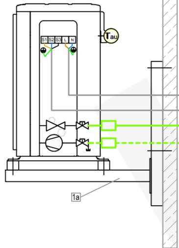
Aussengerät mit Dämpfungssockel
