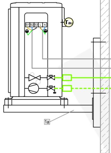
Aussengerät mit Dämpfungssockel
