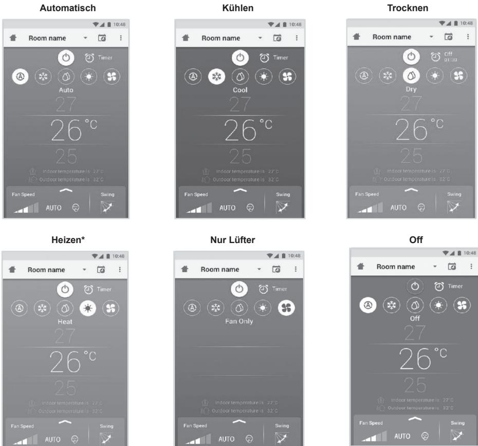
\* Dieser „Heizmodus“ ist nur für Wärmepumpenprodukte verfügbar.
