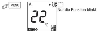
3. Wählen Sie Lamellenschwenk oder HADA Careflow durch Drücken der TEMP-Taste.
