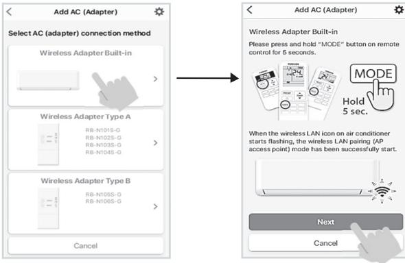
④ Aktivieren Sie den drahtlosen Adapter per Fernbedienung.
