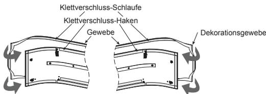
4. Führen Sie das Gewebe in die Ober- und Unterseite des Lufterlassgitters ein. Befestigen Sie Haken und Schlaufen des Klettbandes vollständig aneinander. Wie in der Abbildung unten dargestellt.
