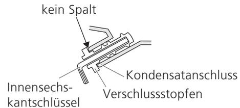
Zum Verschließen des Anschlusses Stopfen mit einem Innensechskantschlüssel eindrücken.
