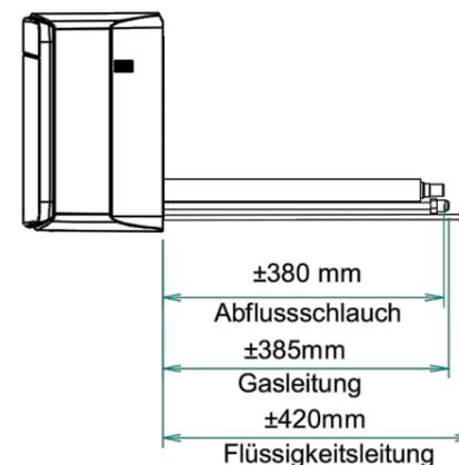
Abmessungen der vollständig geöffneten Frontblende
