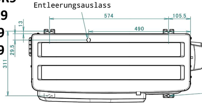
4 Bohrungen für Ankerschrauben
