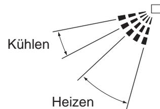
Stoppen Sie die horizontalen Schwenklappen in einer Position, in der Sie die Laschen greifen und nach links oder rechts verschieben können.
