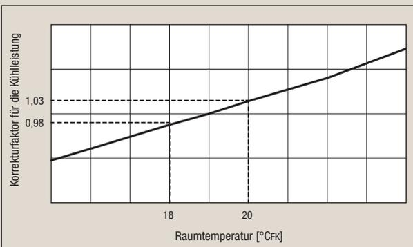
**Abb. 2 Temperaturabhängige Korrektur der Außengeräte**
