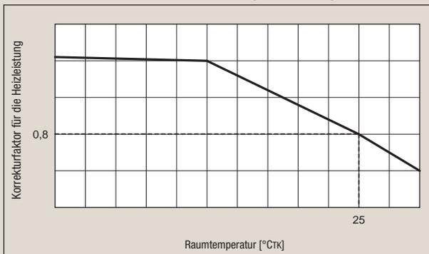
**Abb. 5 Temperaturabhängige Korrektur der Außengeräte**
