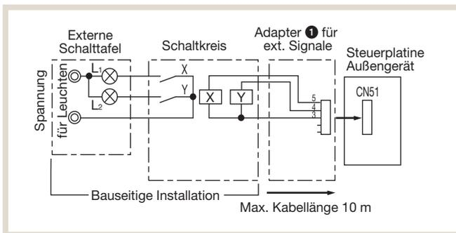
L1 : Störungsanzeige: leuchtet, wenn eine Störung aufgetreten ist
