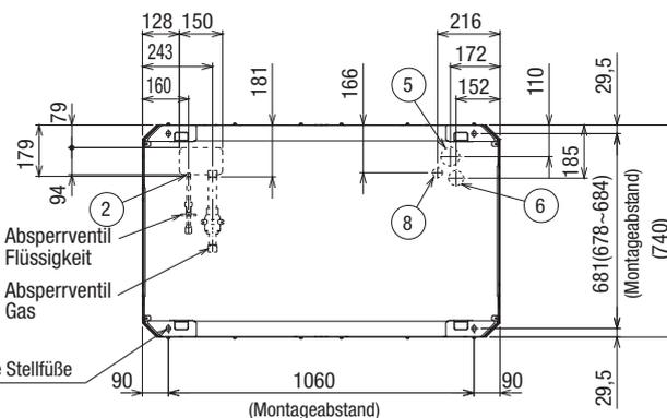
Kältetechnische Anschlussmaße (Alle Lötanschluss)
