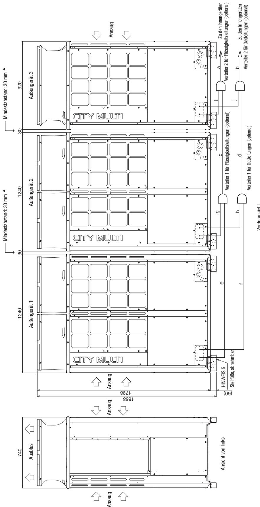
Kältetechnische Anschlussmaße: Einzelmodule und Verteilersatz
