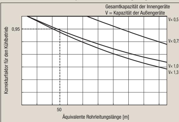
Die Auswahl der Innen- und Außengeräte und Überprüfung der Heizleistungen finden Sie auf den folgenden Seiten. Stellen Sie sicher, dass die korrigierten Kälte- und Heizleistungen die Anforderungen der Vorgaben erfüllen.
