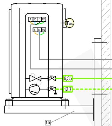
Aussengerät mit Dämpfungssockel
