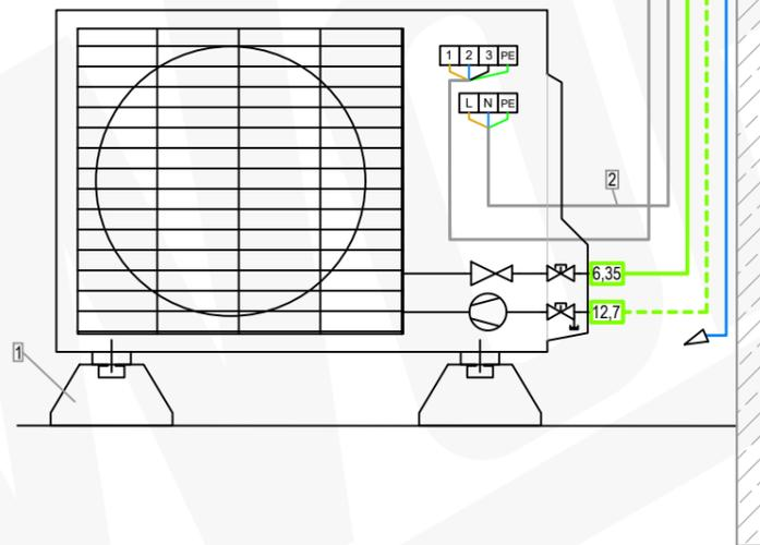
Kondensatablauf mit Kanalpumpe FL-K20K-SW links
