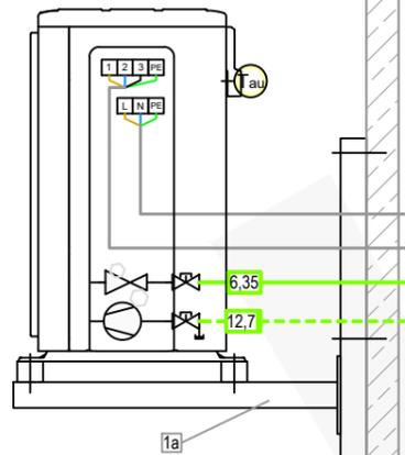
Aussengerät mit Dämpfungssockel
