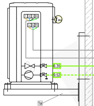
Aussengerät mit Dämpfungssockel
