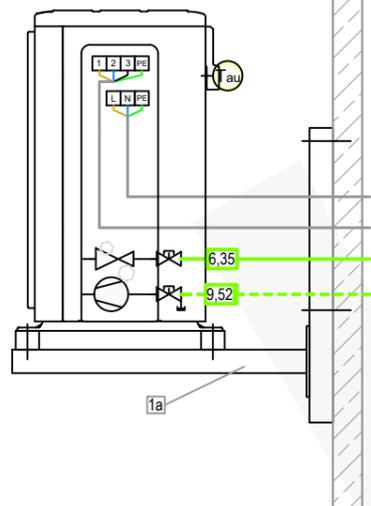
Aussengerät mit Dämpfungssockel
