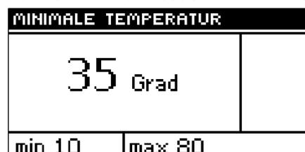
entsprechend hohe Temperatur erreicht hat. Nachdem diese Funktion eingerichtet ist, stellt der Nutzer die minimale zugelassene Temperatur ein.
