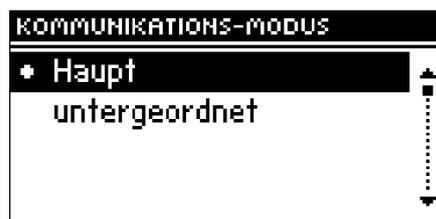
untergeordnete Modus eingestellt wird, arbeitet die Steuerung des Ventils als Modul und alle ihre Einstellungen werden an der Kesselsteuerung vorgenommen.
