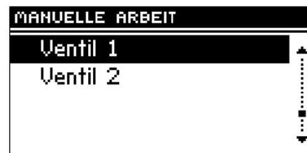
Nach Auswahl der Option *Manueller Betrieb* hat der Anwender die Möglichkeit der manuellen Steuerung des prozentuellen Öffnungsgrads des Ventils (auch eines der Zusatzventile, wenn diese aktiv sind) sowie des Ein- und Ausschaltens der Pumpe zur Kontrolle ihrer richtigen Funktion.
