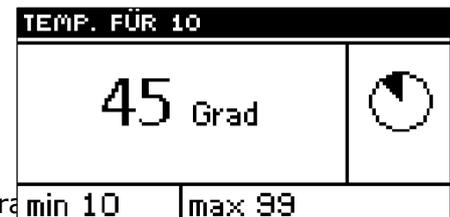
**Heizkurve** – dies ist eine Kurve der Außentemperatur ermittelt wird. In dem Steuergerät ist die Kurve auf der Grundlage von vier Punkten der eingestellten Temperaturen für die jeweiligen Außentemperaturen konzipiert. Die eingestellten Temperaturen werden für die Außentemperatur  $-20^{\circ}\text{C}$ ,  $-10^{\circ}\text{C}$ ,  $0^{\circ}\text{C}$  und  $10^{\circ}\text{C}$  bestimmt.
