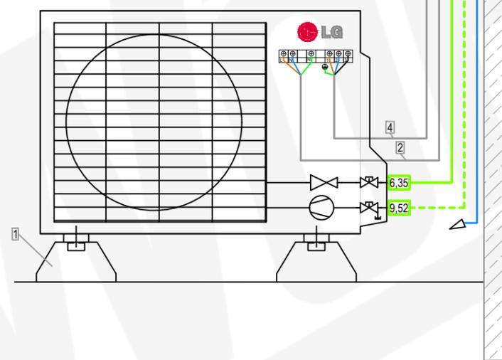
Kondensatablauf mit Kanalpumpe FL-K20K-SW rechts
