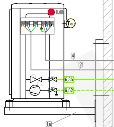
Aussengerät mit Dämpfungssockel
