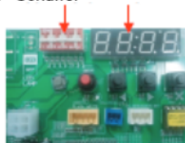
Leiterplatte des Außengerätes
