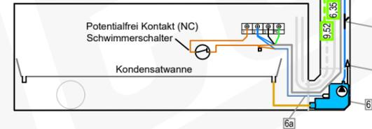
Kondensatablauf mit Kanalpumpe FL-K20K-SW links
