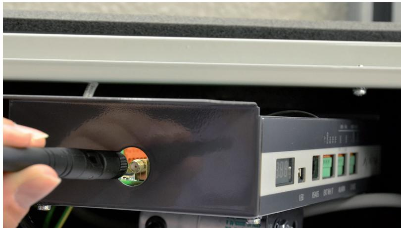
3. War die Kopplung erfolgreich sendet das Gerät eine Seriennummer an die Funkfernbedienung und das Funksymbol wird angezeigt.
