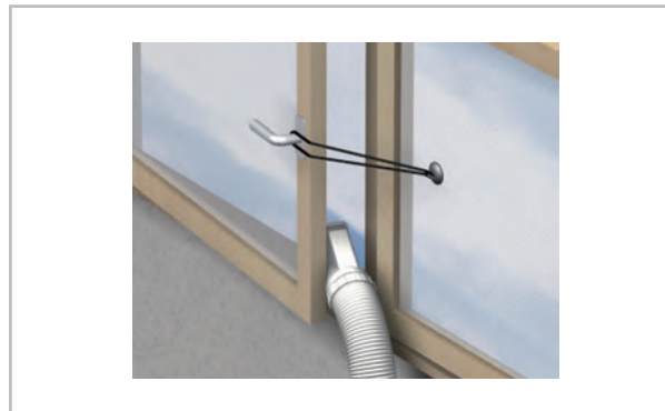
Abb. 10: Abluft bei geöffnetem Fenster
