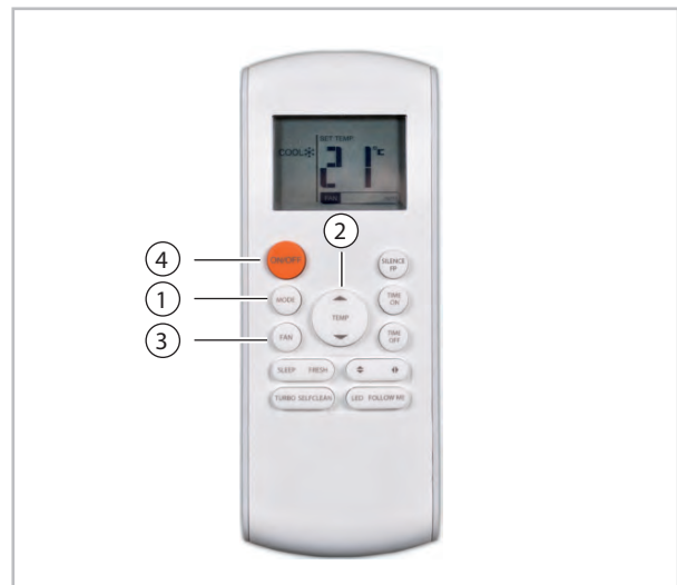
Abb. 12: Modus "Kühlen", "Heizen" und "Umluft"
