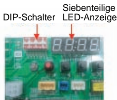
Leiterplatte des Außengerätes
