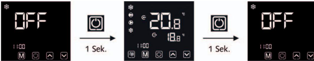
Das Einschalten der Einheit erfolgt durch das Drücken der - Taste für 1 Sekunde.
