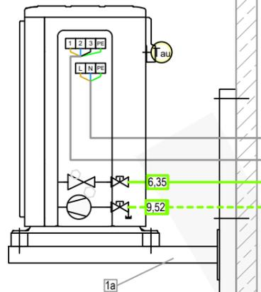
Aussengerät mit Dämpfungssockel
